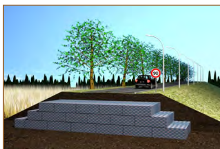
REMBLAI SUR SOL MOU
